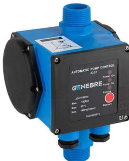
**3254** CONTROLADOR AUTOMÁTICO DE BOMBAS DE AGUA PARA ACTIVAR/ DESACTIVAR EL FUNCIONAMIENTO DE UNA BOMBA EN INSTALACIONES Y SUMINISTROS. ROSCAS DE ENTRADA/SALIDA EN 1”HE. TENSIÓN DE CONEXIÓN 230V 50HZ. INTENSIDAD MÁX. 10A. PRESIÓN DE ARRANQUE 1.5BAR/MAX.PRESIÓN DE TRABAJO 10BAR MÁX.TEMPERATURA DE TRABAJO 60°C. PROTECCIÓN IP65.
