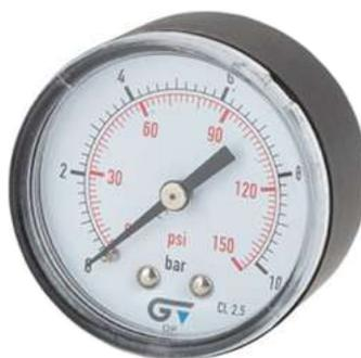
**MANOMETRO Ø 63 CON GLICERINA, CAJA ACERO INOX. AISI 304. TUBO BOURDON Y RACOR EN LATON UNE-EN 12165. ROSCA 1/4” M. GAS. SALIDA INFERIOR (RADIAL):**
