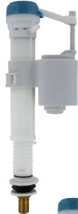
**A126005                    VALVULA DE LLENADO PARA W.C. CON ENTRADA INFERIOR HILO DE 1/2” HE. VALVULA ANTISIFON, REGULACION DE NIVEL DE LLENADO, RESISTENTE A CORROSION Y CLORO. ALTURA DEL CUERPO REGULABLE DE 200 A 285mm. PRESION DE TRABAJO 3 A 116LBS.**
